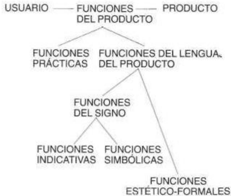
Figura 18: Funciones del Producto. Fuente: Bürdek, B. (1994). Diseño. Historia, teoría y práctica del diseño industrial. Barcelona: Gustavo Gili.
