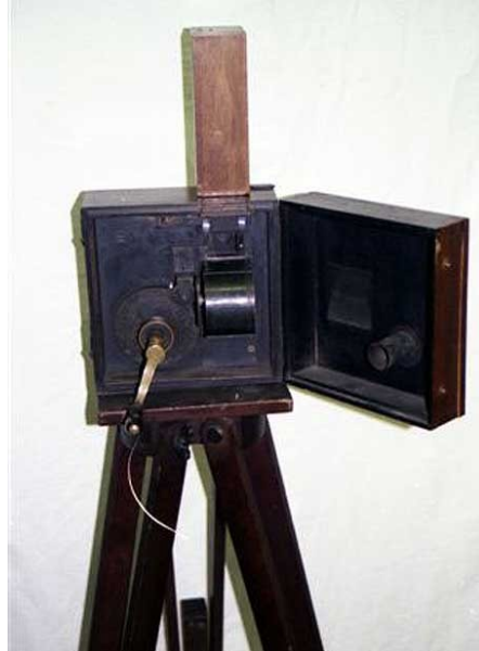
Figura 1. Cinematógrafo. Fuente: La Academia de Cine expone el primer cinematógrafo de Lumière. 2007. El País. Disponible en: http://www.elpais.com/articulo/espana/Academia/Cine/expone/primer/cinematografo/Lumiere/elpepuesp/20071221elpepunac_19/Tes
