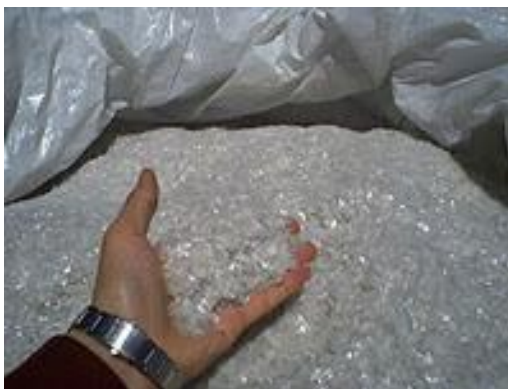
Figura 7: PET reciclado: es liviano, transparente, cristalino y admite colorantes.
