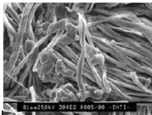
Figura 6: Microcápsulas antes del lavado en los tejidos impregnados con M.G.G. Fuente: INTI. Miró Specos, et. al. (2009). Obtención de textiles con acabados a base de productos microencapsulados . Buenos Aires, Argentina
