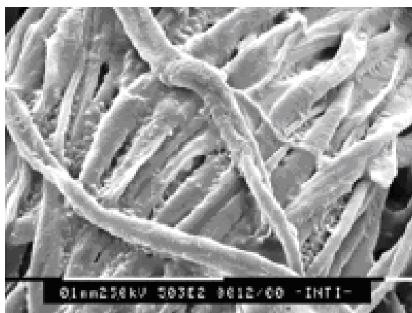
Figura 10: Microfotografía M.E.B. de un tejido lavado, impregnado con microcápsulas de levadura con aceite esencial de limón encapsulado. Fuente: INTI. Miró Specos, et. al. (2009). Obtención de textiles con acabados a base de productos microencapsulados . Buenos Aires, Argentina.
