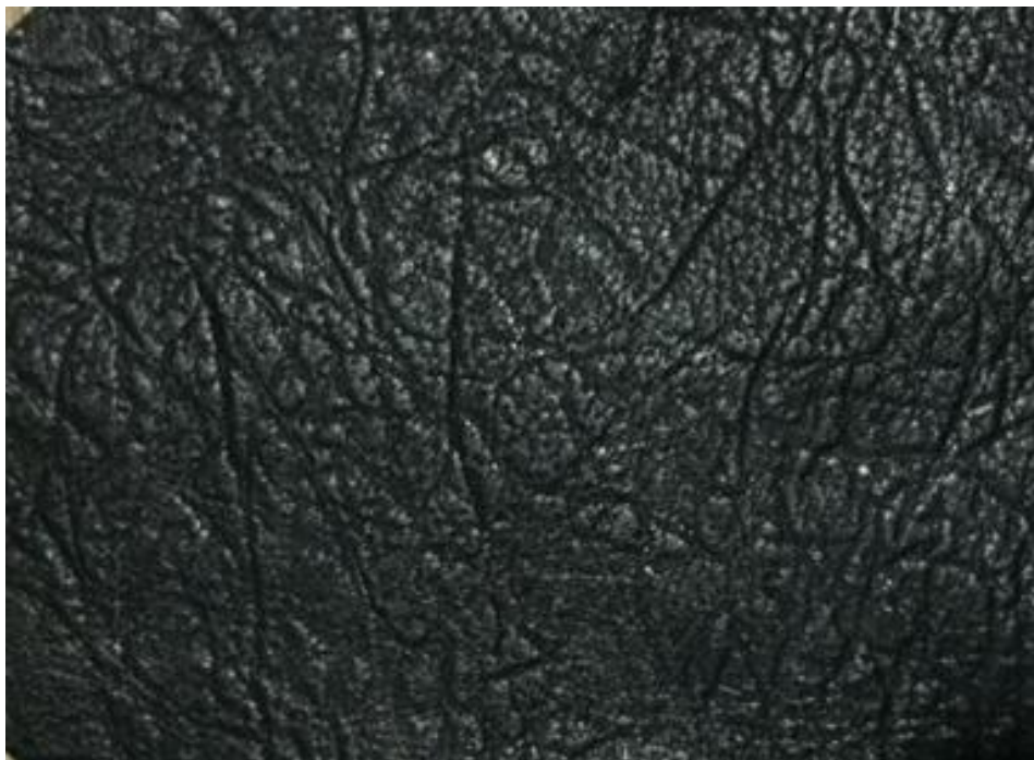
Figura 4. Cuero de oveja con proceso de grabado. Fuente: elaboración propia.
