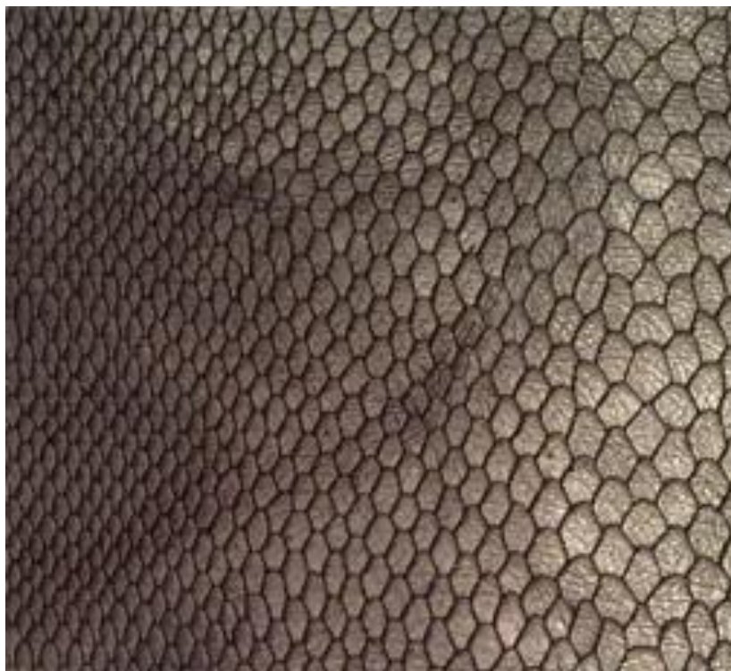
Figura 1. Cuero de oveja con proceso de foliado peltre y grabado. Fuente: elaboración propia.
