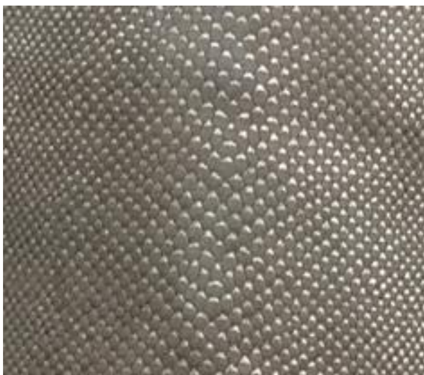
Figura 2. Cuero de oveja con proceso de foliado peltre, grabado y gastado. Fuente: elaboración propia.
