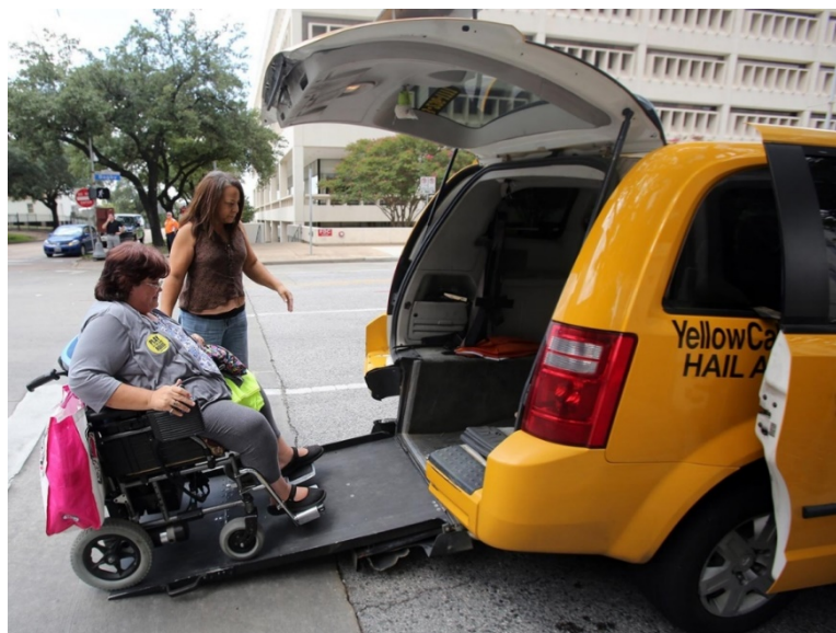
Figura 2: Rampa de acceso a Taxi norte americano. Fuente: newmobility (2013). Recuperado de: http://www.newmobility.com/2013/11/nyc-wheelchair-accessible-taxi-medallions-auctioned-for-millions/
